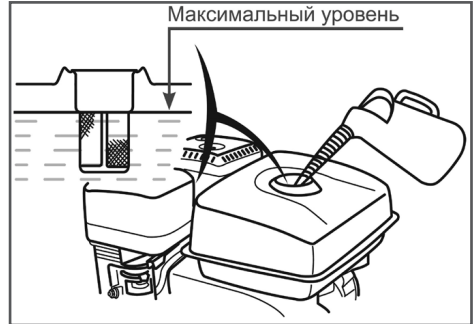
Рис. 5 Максимальный уровень топлива в топливном баке
