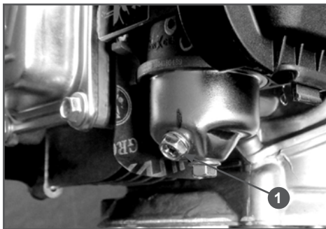
Рис. 11 Слив топлива из карбюратора
