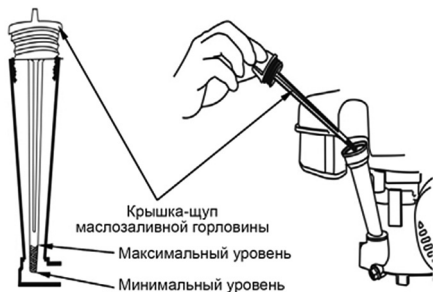
Рис. 8 Проверка уровня масла в картере
