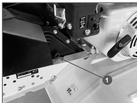
Рис. 25 Расположение пробки отверстия для добавления смазки в редуктор 1. Пробка
