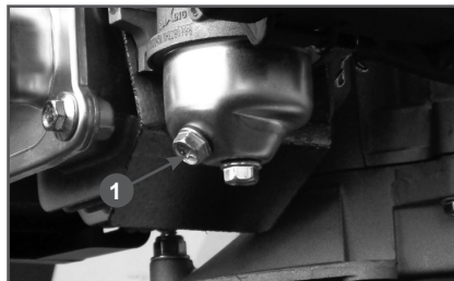
Рис. 20 Слив топлива с поплавковой камеры карбюратора
