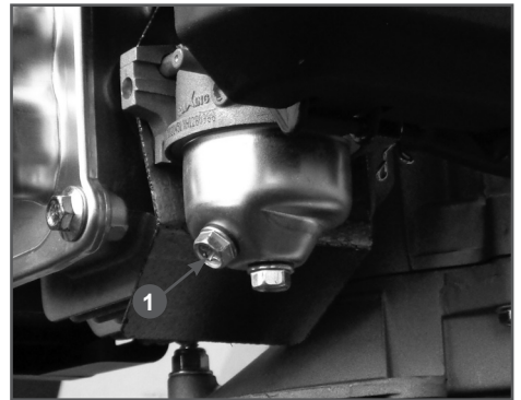
Рис. 19 Слив топлива из карбюратора 1. Болт сливной
