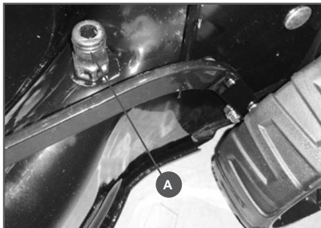
**Рис. 15** Расположение коннектора для подключения шланга
