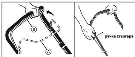
**Рис. 7 Запуск двигателя**
